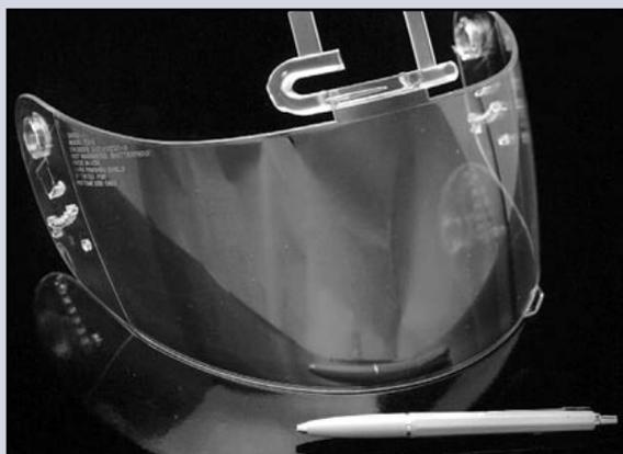
聚碳酸酯制的摩托车安全头盔镜片最初采用AISI 420制模,后由于高抛光要求改为STAVAX ESR.
