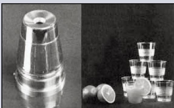
制造一次性聚苯乙烯杯子的STAVAX ESR型芯，该模具已生产了几百万个同精度公差的高表面质量产品
