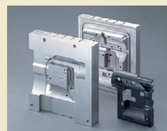
ウェルドレス金型の一例 Weldless Molds
