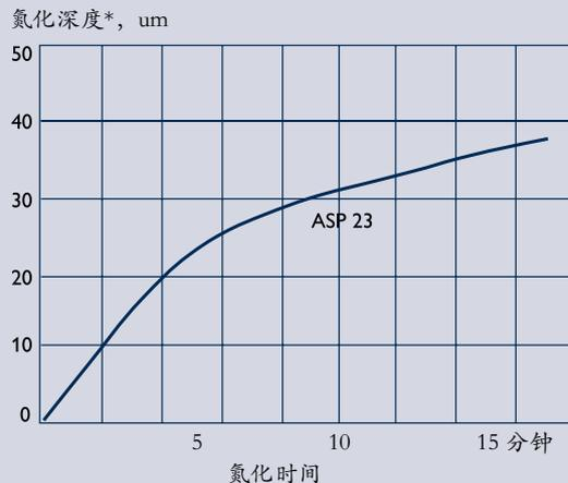
\* 氮化深度指表面到比基体硬度高50HV处的距离
